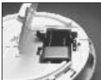
**ATTENTION!** Si vous n'enfoncez pas le levier de sécurité à l'intérieur du compartiment à pile avant d'y insérer celle-ci, le couvercle du compartiment ne se fermera pas. Il vous sera impossible de remettre l'attache-câble à connexion rapide en place et de réajuster l'avertisseur à la plaque de fixation.
