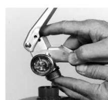
5. Appuyez sur la tige de la soupape située sous la poignée de décharge en utilisant votre doigt ou un outil approprié.
