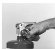
17. Tournez la soupape dans le sens horaire jusqu'à ce qu'un déclic se fasse entendre. Cela indique l'engagement des filets et minimise les dommages. Serrez la soupape à la main dans le sens horaire.
