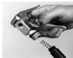
4. Détachez le tuyau de succion de la soupape en le tournant dans le sens antihoraire. Enlevez le ressort.
