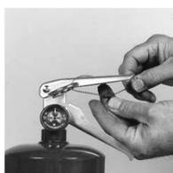
21. Placez une goupille à travers le corps de la soupape et la poignée de décharge. Fixez un sceau.
