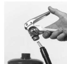
14. Remettez le ressort sur le tuyau de succion puis tournez celui-ci dans le sens horaire dans le corps de soupape.
