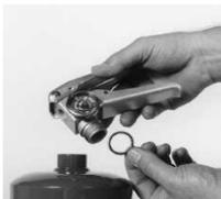
6. Retirez le joint torique du corps de la soupape.
