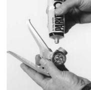
9. Lubrifiez le joint torique sur toute sa circonférence. Strike First recommande d'utiliser le lubrifiant « Parker O-Lube ».
