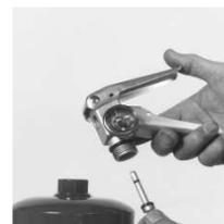
13. Réinsérez l'assemblage de la tige de la soupape dans le corps de soupape. Mettez-la en place avec votre doigt.
