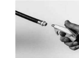
22. Vérifiez la buse et/ou le tuyau pour la présence de blocages et remettez-les sur l'unité.
