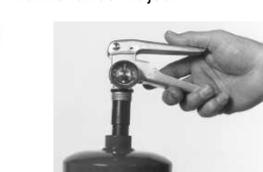
16. Remettez le bon tuyau de succion et la bonne soupape nettoyée sur la bonne bouteille. **REMARQUE :** Remettez la soupape et le tuyau de succion immédiatement après le remplissage de la bouteille et pendant que la poudre est encore dans un état aéré.
