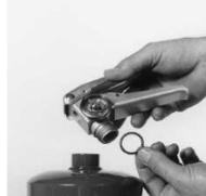
8. Inspectez soigneusement le nouveau joint torique du corps de la soupape et installez-le. Faites attention de ne pas endommager le joint torique sur les filets du corps de la soupape.
