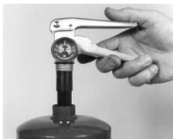
3. Retirez la soupape et le tuyau de succion de la bouteille en les tournant dans le sens antihoraire. Marquez les soupapes et les cylindres si vous effectuez la maintenance de plus d'une unité. Enlevez les résidus chimiques en inversant la bouteille. Ne pas le faire pourrait entraîner le tassement de la poudre.
