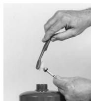
11. Nettoyez le siège de la soupape contenant le caoutchouc d'étanchéité. Strike First recommande de remplacer l'assemblage de la tige de la soupape à chaque intervalle de maintenance majeur.
