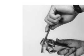
7. Nettoyez soigneusement l'intérieur et l'extérieur des filets du corps de la soupape avec une petite brosse en accordant une attention particulière à la zone du siège de la soupape. **Portez une attention particulière à la rainure de décharge de la pression dans les filets du corps de la soupape.**
